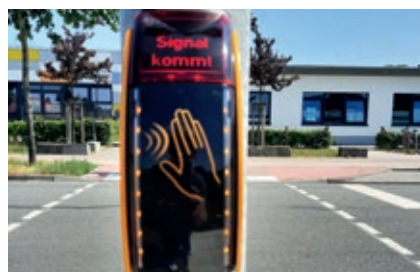
Ganz neu: Die erste Lichtsignalanlage in Delmenhorst funktioniert ganz ohne manuelle Bedienung.
